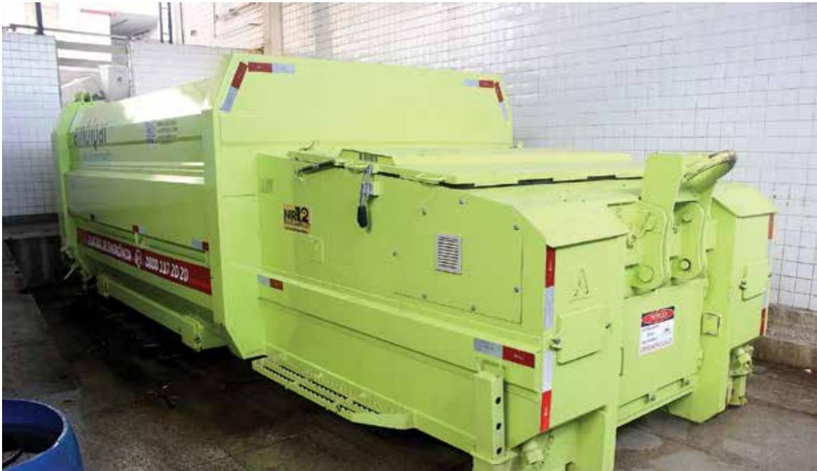
Com 17m<sup>3</sup>, nova compactadora aumentou, substancialmente, a coleta de resíduos
